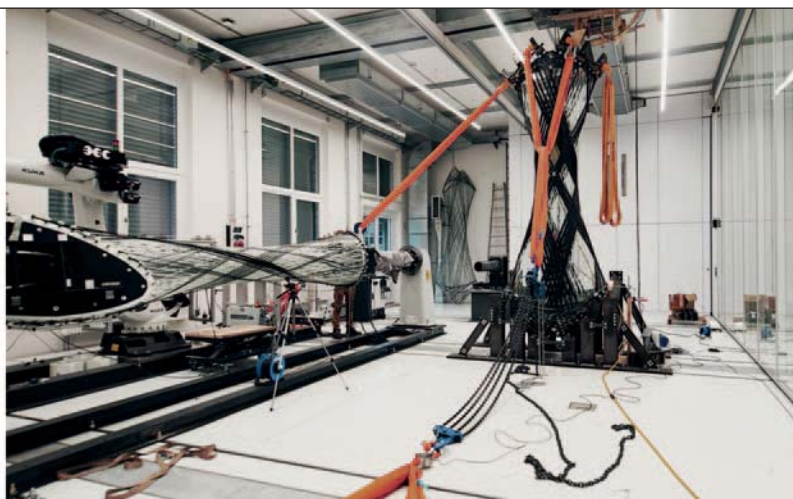
Abb. 11: Versuche zur Ermittlung der Tragfähigkeit der Faserverbundkomponenten
