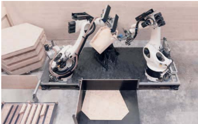
Abb. 3: Mobile robotische Verarbeitungsplattform zum Fügen und Fräsen der Holzkassetten
