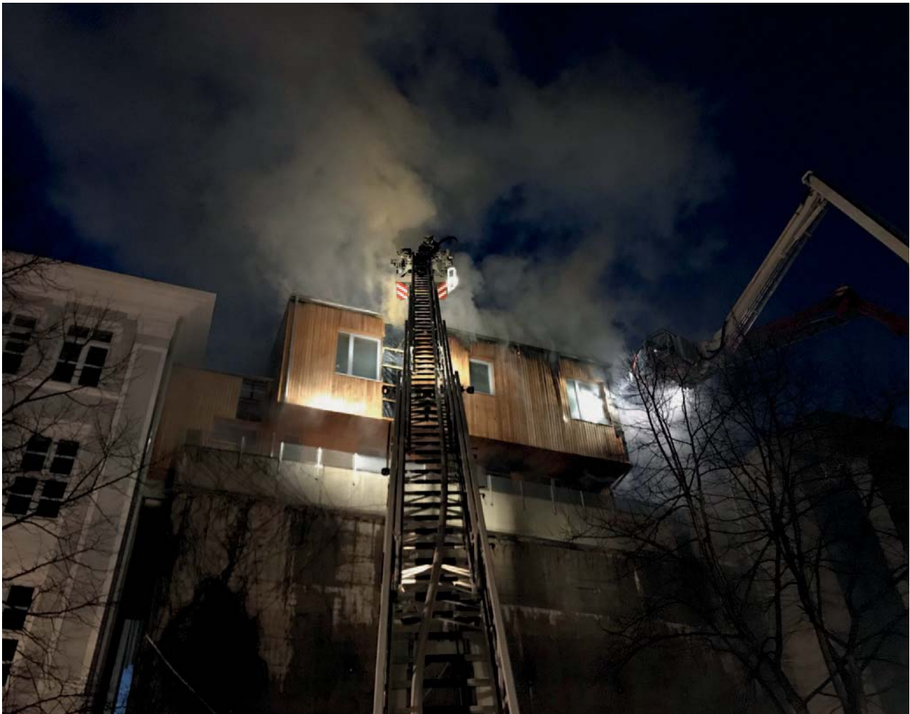
Abb. 4: Der Einsatz von Hubrettungsgeräten zur Brandbekämpfung ist in der Bauordnung nicht berücksichtigt. Bei Bränden in Holzbauten stellt dies eine Herausforderung dar, die bislang nur bei Dachstuhlbränden zur Geltung kam.
