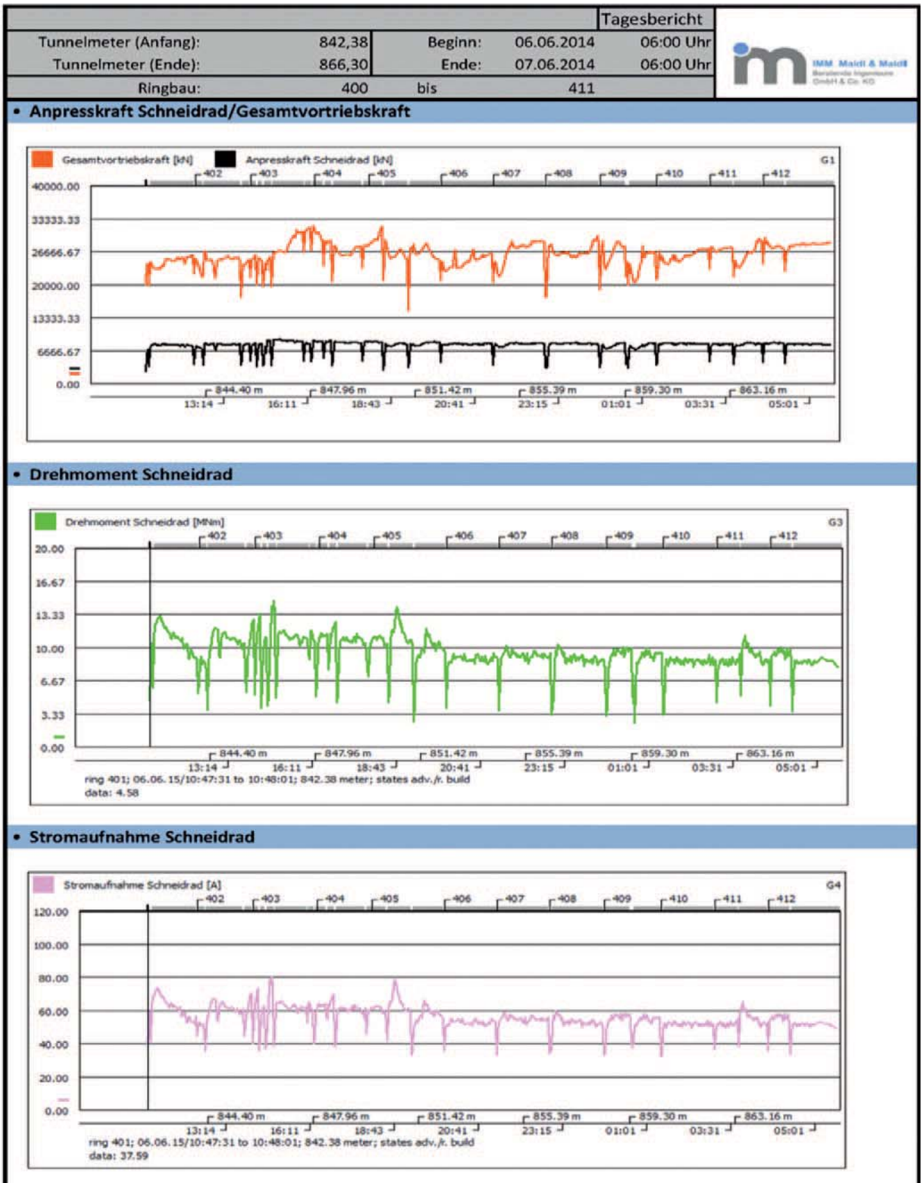
Abb. 2: Beispielhafter Auszug Prozesscontrolling während des Vortriebes
