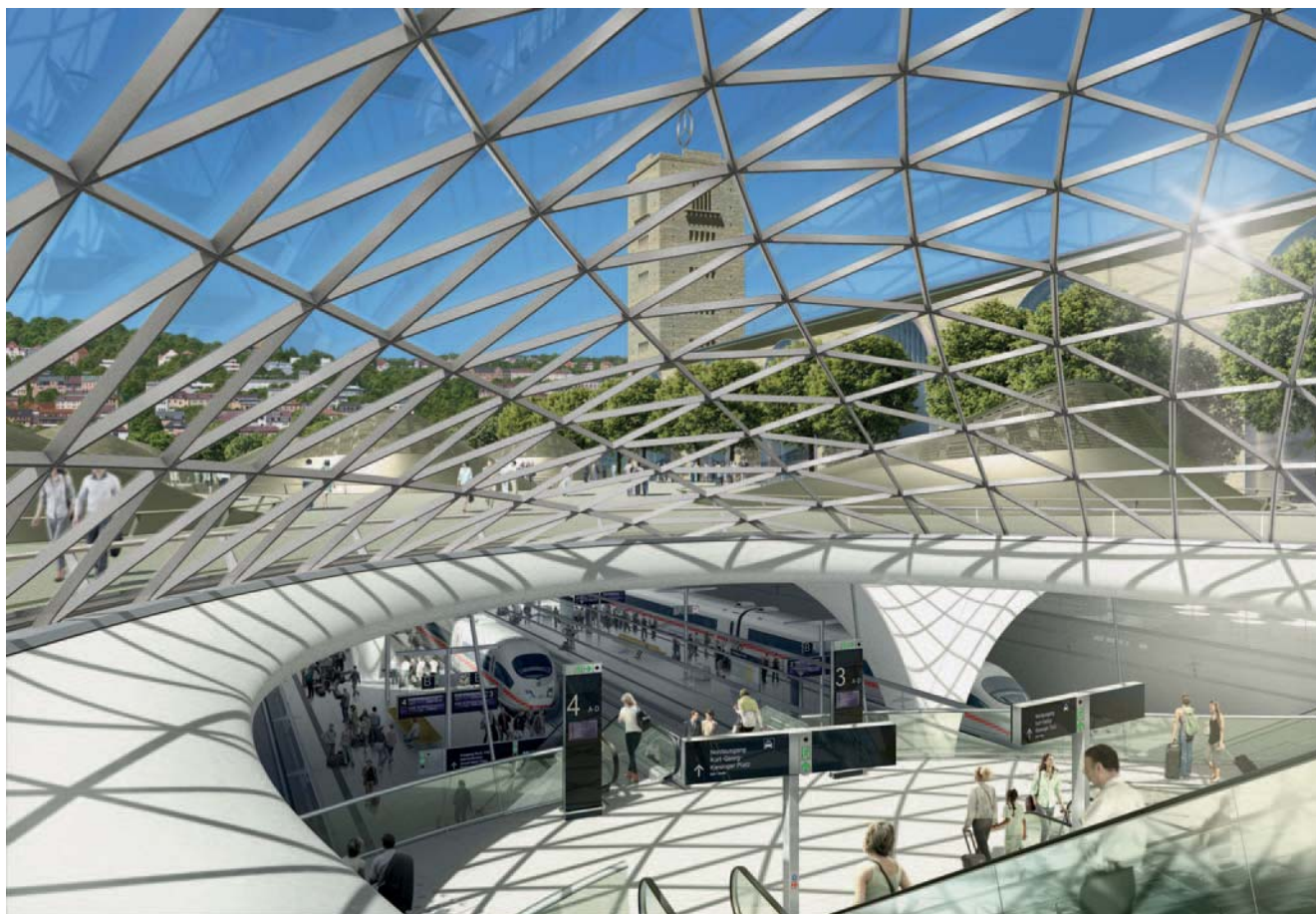
Abb. 3a: Untersicht der Stahl-Glas-Schale, die den Sonderkelch (Eingangsbauwerk) überspannt
