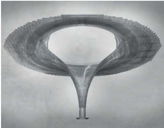
Abb. 5: Schematische Darstellung der Bewehrung einer Kelchstütze samt Fuß
