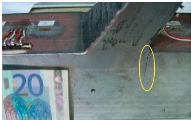
Abb. 8: Versuchskörper einer ermüdungsbeanspruchten Schweißnaht mit deutlich erkennbarer Rissbildung
