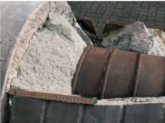
Abb. 9: Geöffneter Versuchskörper einer Groutverbindung
