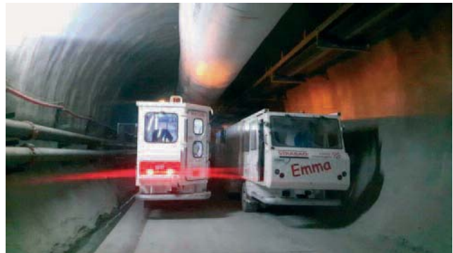
Abb. 11b: ... und einer Geschwindigkeit von bis 25 Kilometern pro Stunde automatisch und ohne lenkenden Fahrer durch den Tunnel bewegt und ...
