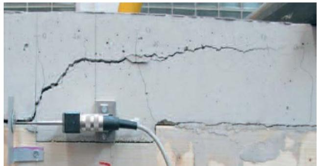
Abb. 16: Querkrachtriss am Versuchskörper
