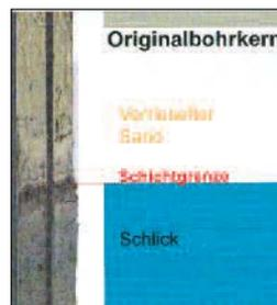
Abb. 17: Verrieselte Fläche im Originalbohrkern
