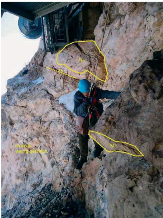
Abb. 5: Gefügeaufnahme in der Nordwand
