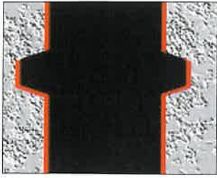
Abb. 20: Rissbildung bei einbetonierten Bewehrungsstäben (nach [10])
