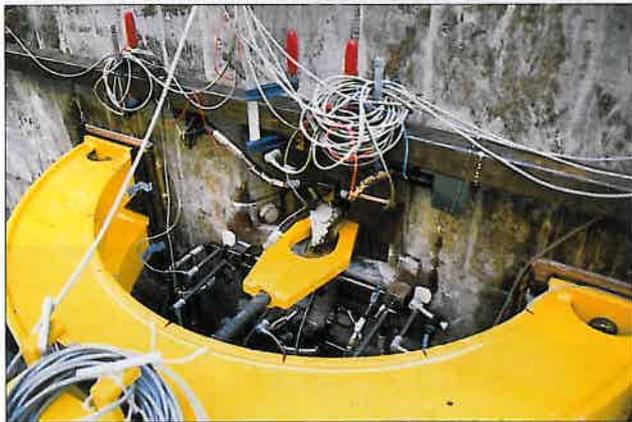
Abb. 25: Testlastvorrichtung für den Pollerzapfen mit variabler Zugrichtung
