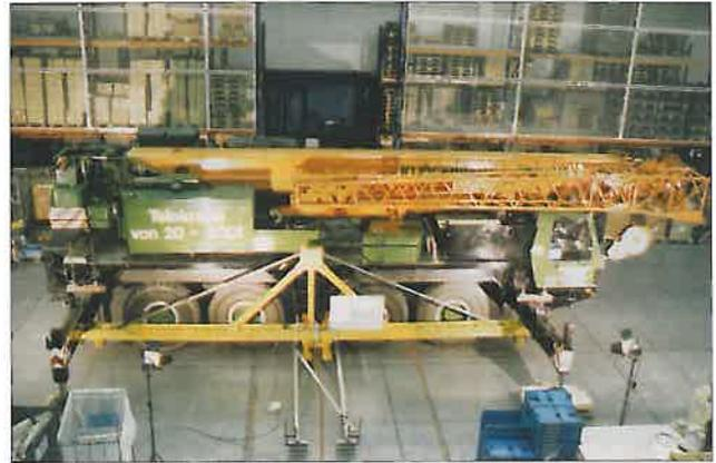
Abb. 14: Erzeugung der verfahrbaren variablen Testlast mit Hilfe eines 54-t-Mobilkranes mit Standardbelastungsgeschirr
