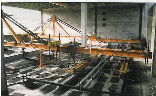
Abb. 7: Lastgeschirr und Meßtechnik auf der alten Dachdecke
