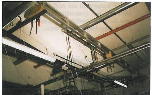
Abb. 9: Die Nebenunterzüge (Fischbauchträger) spannen über  $l = 11,7$  m. Aufnahme der Bauteilreaktionen: Stahldehnungen, Betonstauchungen, Schallemission, Rißweiten, Durchbiegungen
