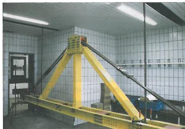
Abb. 3: Mobiler Belastungsrahmen für  $ext F_u \leq 750 \text{ kN}$
