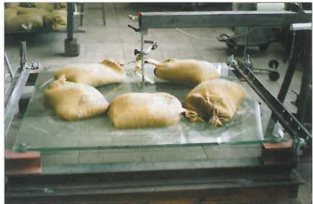
Abb. 2: Resttragfähigkeitsversuch an punktgelagertem VSG aus TVG
