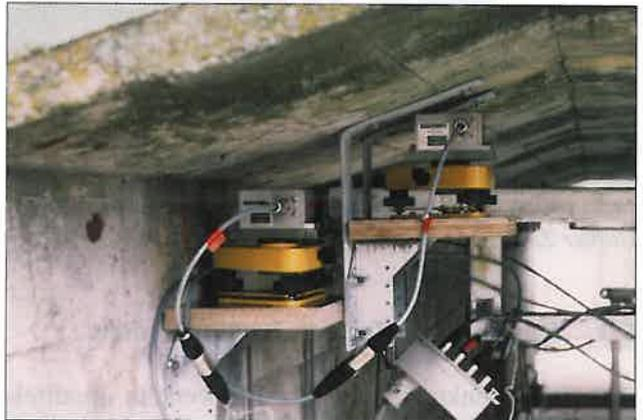
Abb. 33.: Durch umfangreiche Meßtechnik, insbesondere Neigungsmesstechnik, konnte eine günstige Rahmentragwirkung der Stahlbetonbrücke nachgewiesen werden.
