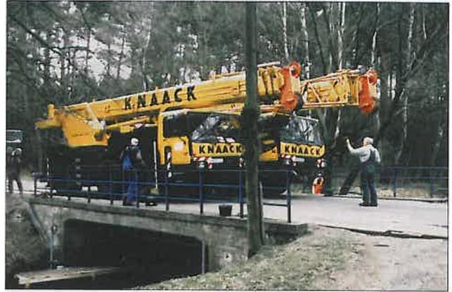
Abb. 32: Überfahrt durch zwei 36-t-Mobilkrane zur Teillasterzeugung
