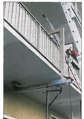
Abb. 11: Hebelarm und Meßbasis
