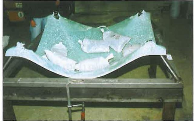
Abb. 1: Resttragfähigkeitsversuch an punktgelagertem VSG aus ESG
