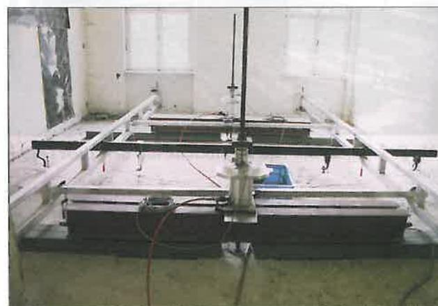
Abb. 4: Lastgeschirr und Meßbasen zur Verschiebungsmessung
