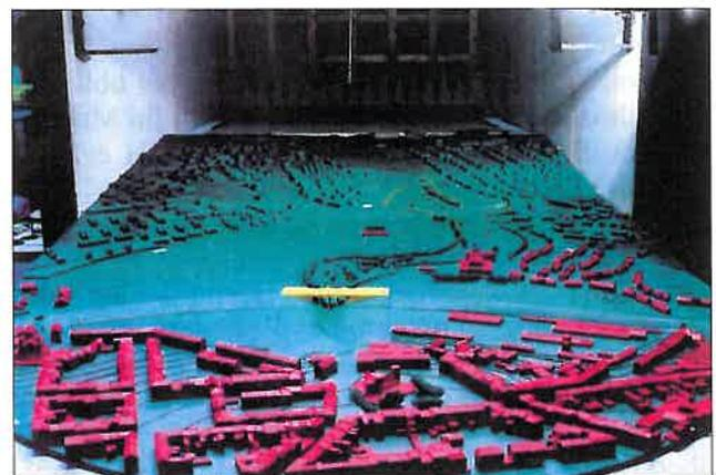
Abb. 6: Blick über ein Stadtmodell (Vordergrund) in die Anlaufstrecke des I.F.I.-Grenzschichtwindkanals
