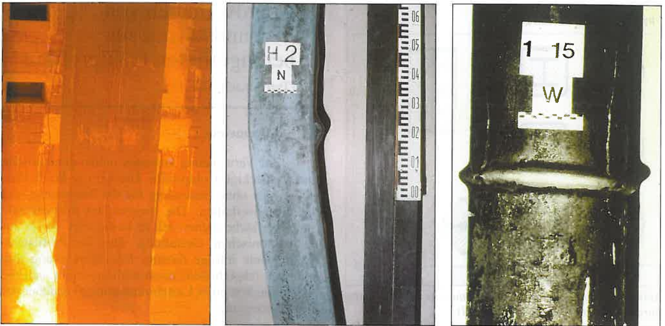
Abb. 10: Lokales Beulen des Hohlprofil-Mantels bei Brandbeanspruchung
